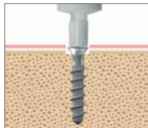
8. Posizionamento della fixture nel sito osseo con il digitale di trasferimento
