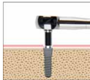
2. Avvitare l'impianto TC/CC Multysystem con il cricchetto completo di adattatore
